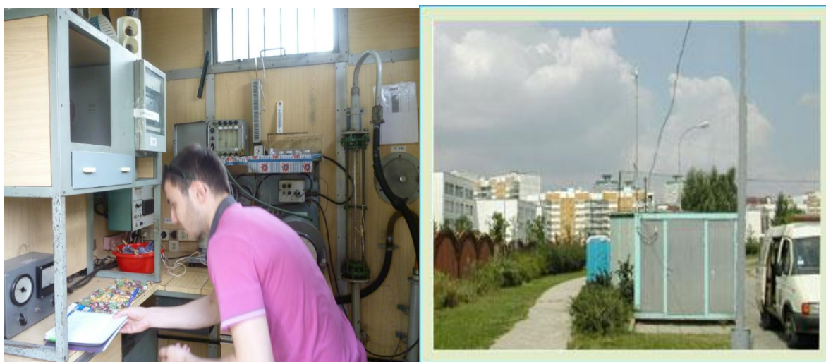
Рисунок 4. станция наблюдения за состоянием городского воздуха
