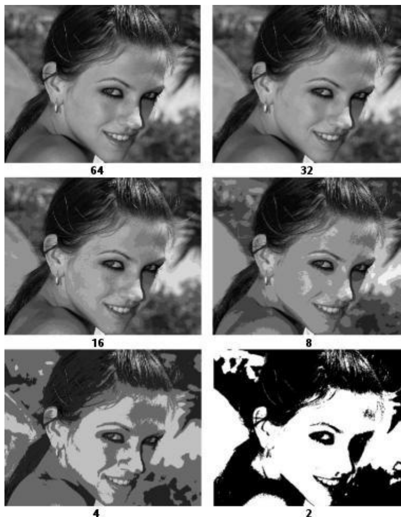
Рис. 14.2. Влияние квантования изображения на его качество: цифрой внизу показано количество уровней квантования
