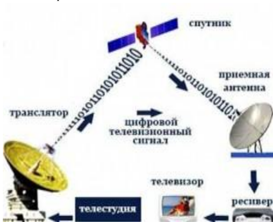
Рис.1. Схема организации спутникового непосредственного ТВ вещания.
