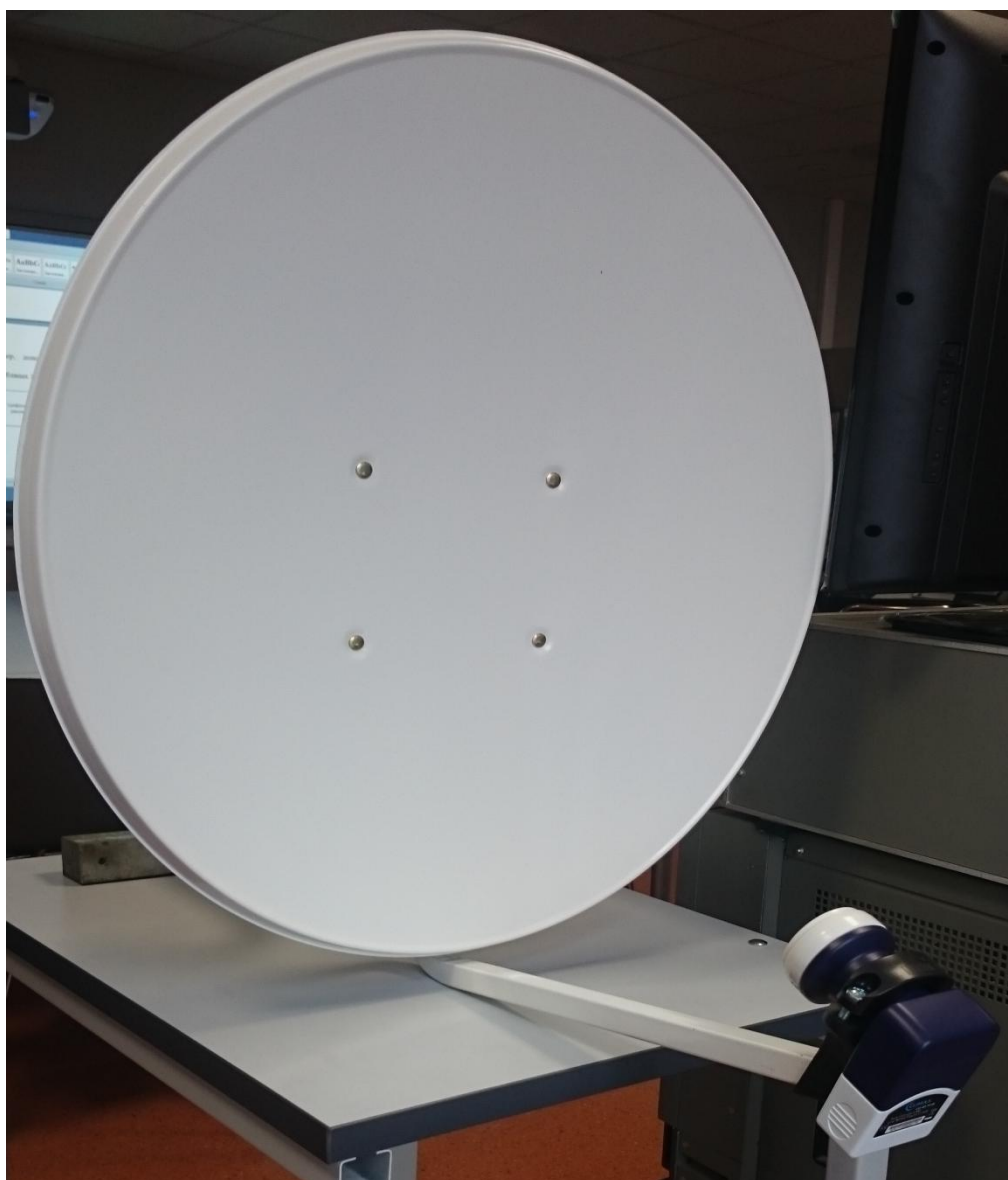
Рис.5. LNB TWIN 2 выхода и его крепление на антенне.
