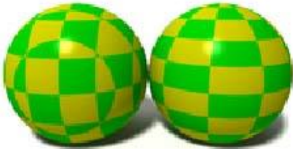
Рис. 4. Шахматная текстура на сфере: слева — общая матрица на всю сферу, справа — развёртка с равнопромежуточной проекцией.
