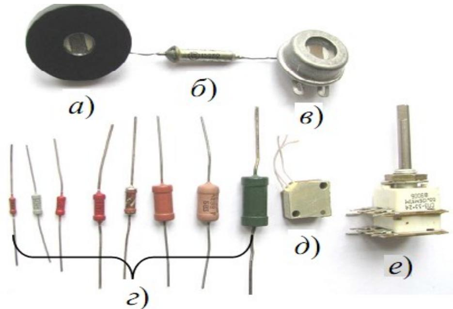
Внешний вид некоторых видов резисторов: а, в – фоторезисторы; б – терморезистор; г – непроволочные постоянные резисторы общего назначения различной мощности; д – подстроечный резистор; е – сдвоенный переменный резистор
