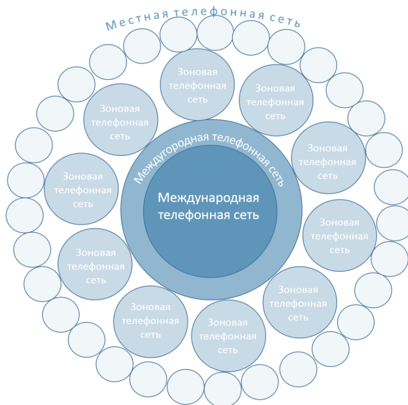
Рисунок 9. Структура телефонной сети
