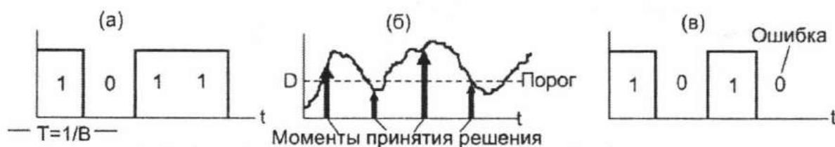
Рис. 29. Схема появления ошибки при восстановлении бинарного сигнала с модуляцией по интенсивности с NRZ кодированием; (а) сигнал на входе в линию, (б) сигнал на входе в регенератор, (в) сигнал на выходе регенератора.
