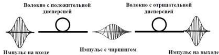
Рис. 1.19. Прохождение оптического импульса через два участка ОВ одинаковой длины и с одинаковой по модулю, но противоположной по знаку хроматической дисперсией [1]. В первом ОВ \beta_2 > 0 , возникающий чирпинг C > 0 , а во втором ОВ \beta_2 < 0 и C < 0 .
