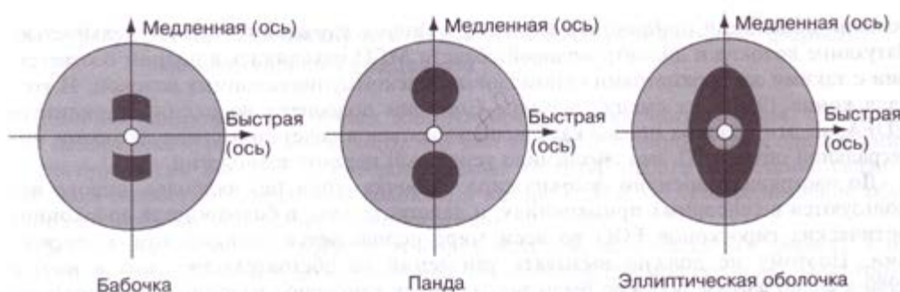
Рис. 4. Поперечное сечение волоконных световодов конфигураций «галстук-бабочка», «панда» и с эллиптической оболочкой
