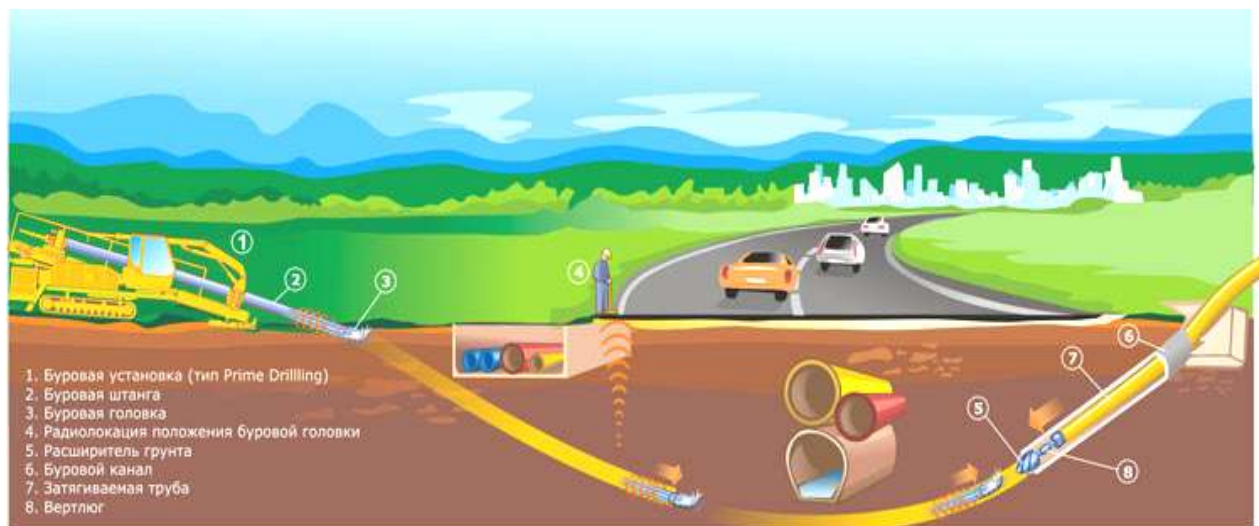
Рис.9.8. Схема организации перехода через автодорогу.
