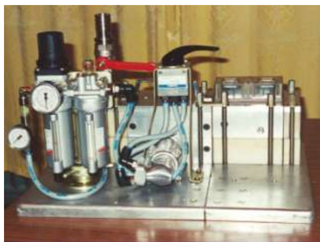
Рис.9.5. Инжектор ПСИ-1 для задувки кабеля
