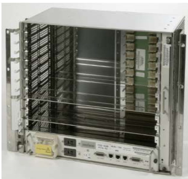
Рис. П.4.3: Внешний вид полки ISAM 7330 FD без плат
