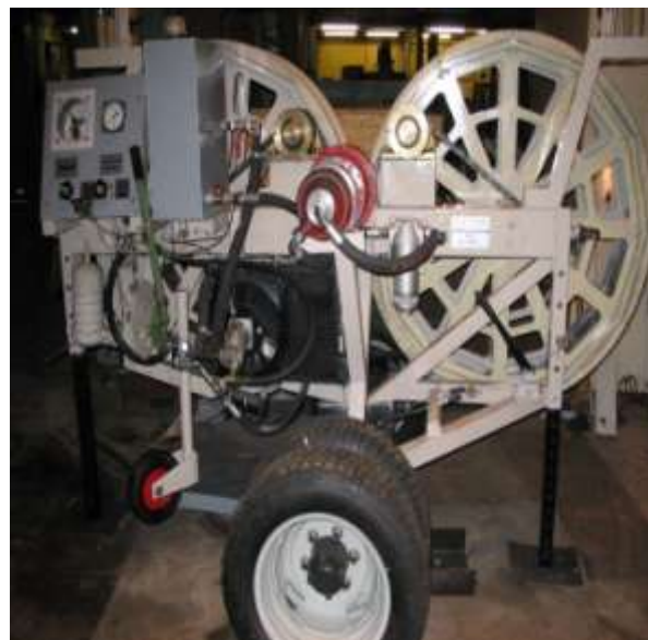
Рис.9.13. Натяжная и тормозная машина для самонесущего ВОК.
