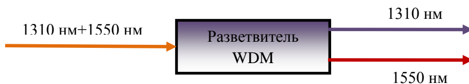
Рис.3.12. Схема WDM-сплиттера. Работа при разделении каналов.
