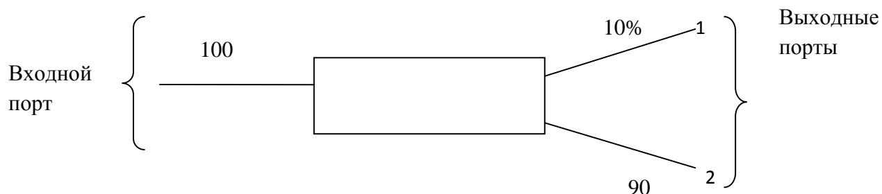
Рис.3.2. Работа асимметричного разветвителя.
