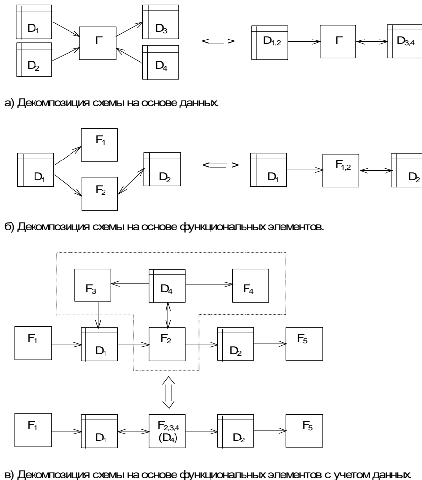
Рис. 2.5. Структурные преобразования схем, ориентированных на потоки данных.
