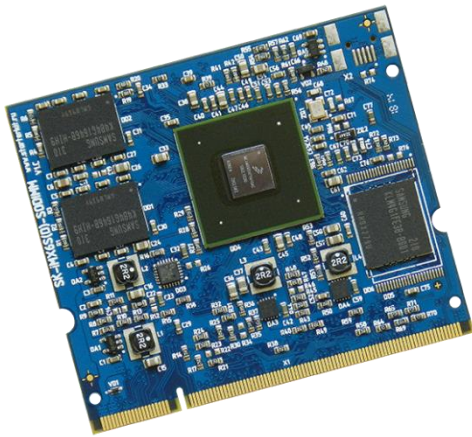
Cortex-A9 2 × 1 ГГц Формат SODIMM
