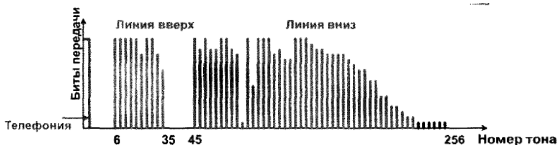
Рис. 2. Дискретная многотоновая модуляция DMT в технологии ADSL.
