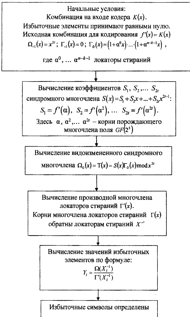
Рис. 2.1. Схема кодирования по алгоритму Евклида
