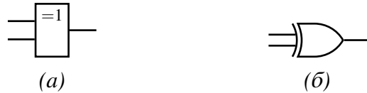
Рис. 2.5. Условно-графические обозначения сумматора по модулю 2: (а) по стандартам IEC и ЕСКД; (б) по стандартам MIL/ANSI и CDH
