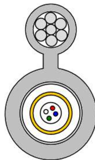
Рис. 1.5. Поддерживающий силовой элемент («восьмерка»)
