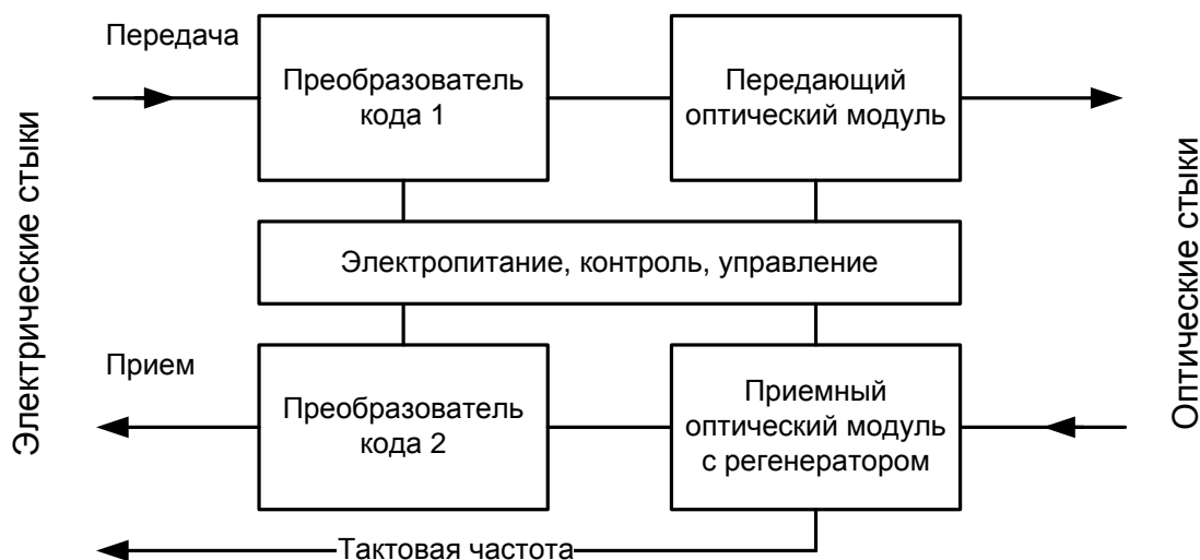
Рис. 1.6. Схема оптического конвертера
