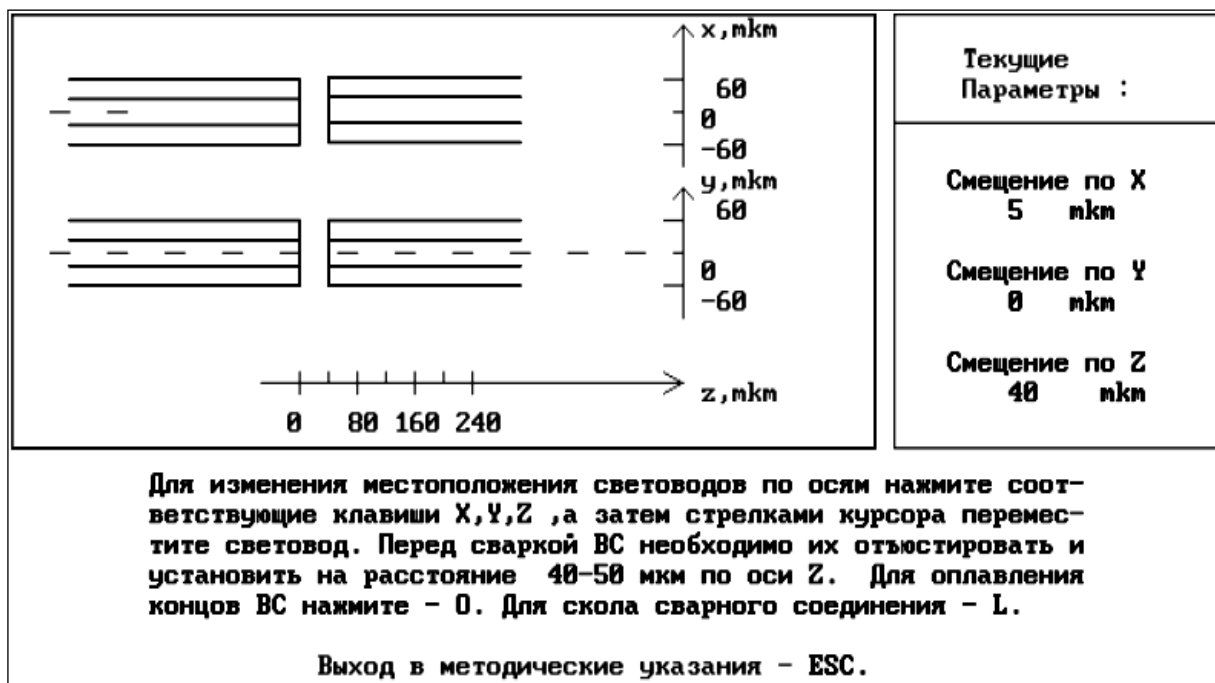
Рис. 6.2. Экран сварочного аппарата
