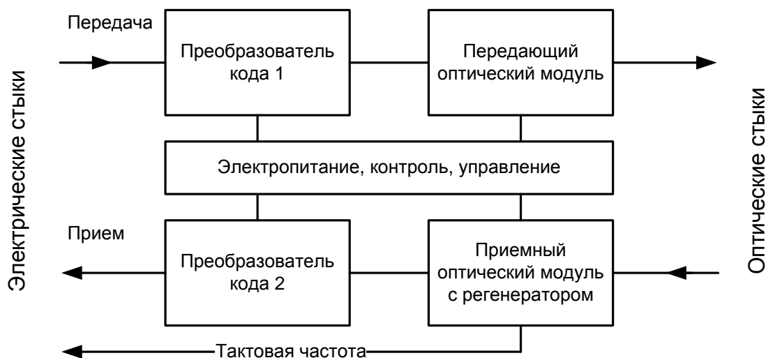
Рис. 1.6. Схема оптического конвертера
