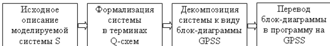
Рис. 5.1. Процесс создания модели с использованием GPSS/PC
