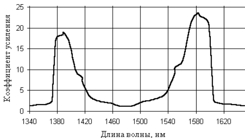
Рис. 11. Спектральная кривая стоксового и антистоксового усиления в кварцевом волокне
