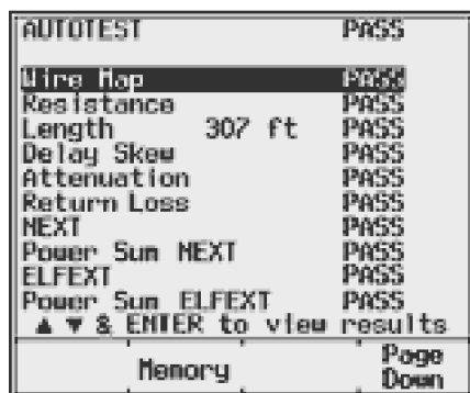
Autotest, запускаемый одним нажатием, обеспечивает показанные выше результаты тестирования
