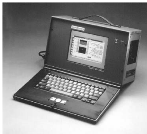
Рис. S5.3. Мобильная станция контроля сети NQMS
