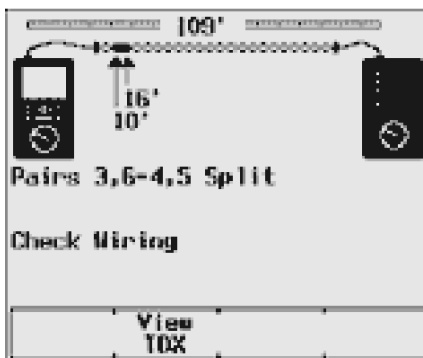
Fault Info (Информация о неисправностях) графически отображает связи кабелей и место неисправности
