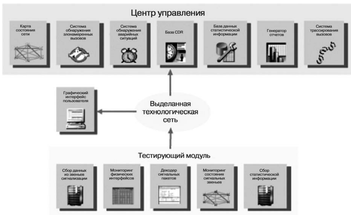
Рис. S3.2. Архитектура системы SpiderNM
