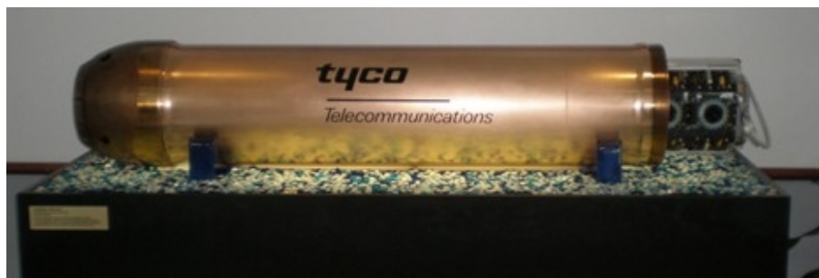
Рис. 28. Общий вид подводного оптического усилителя (производство Tyco Telecommunications) [5].
