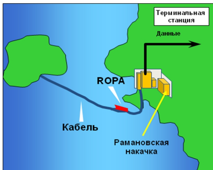
Рис. 6. Безрепитерная линия связи с применением ROPA (Remote Optically Pumped Amplifier) и удалённой рамановской накачки [3].
