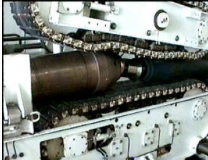
Рис. 14. Гусеничная машина по укладке кабеля (через машину пропускается блок оптического усилителя) [9].
