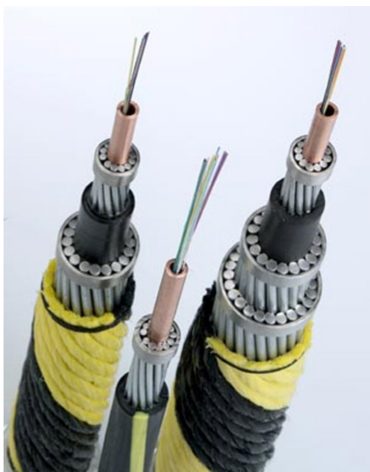
Рис. 20. Бронированный, облегчённый и дважды бронированный оптоволоконные кабели. В качестве внешней защитной оболочки используется повив из полипропиленовой пряжи [10].
