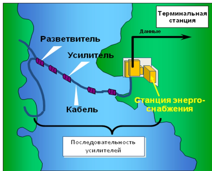
Рис. 2. Магистральная трансокеанская волоконно-оптическая линия связи [2].
