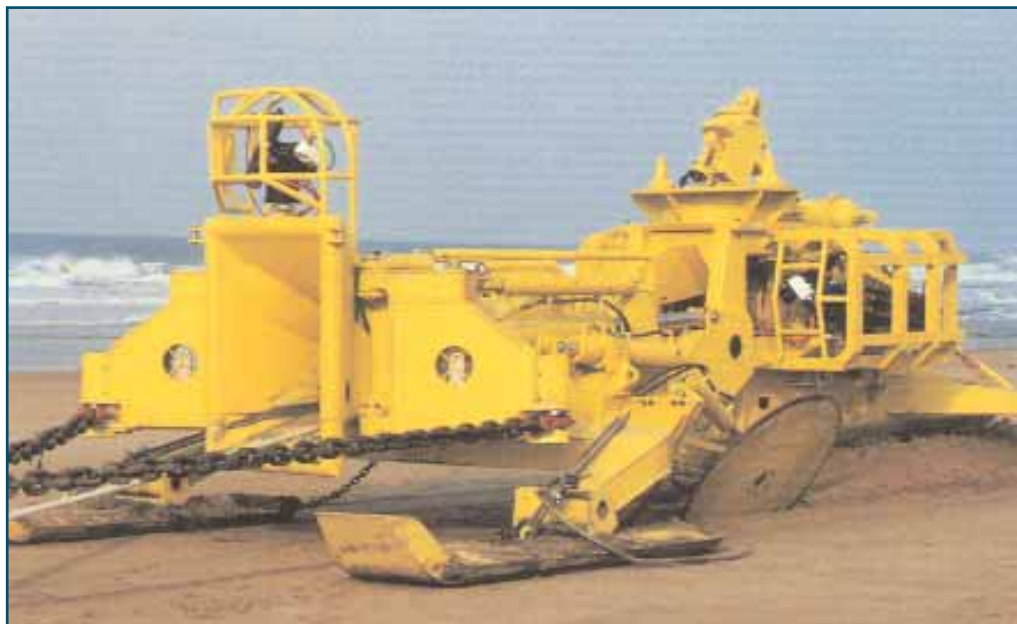
Рис.2. Буксируемый кабельный плуг. Слева виден приемный блок через который проходит подводный кабель.
