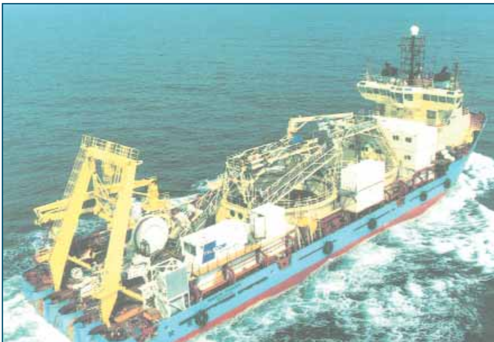
Рис.3. Кабельное судно «Мерск Файтер». С кормы видна «П»-образная гидравлическая подъемная ферма для спуска под воду и подъема кабельного плуга.
