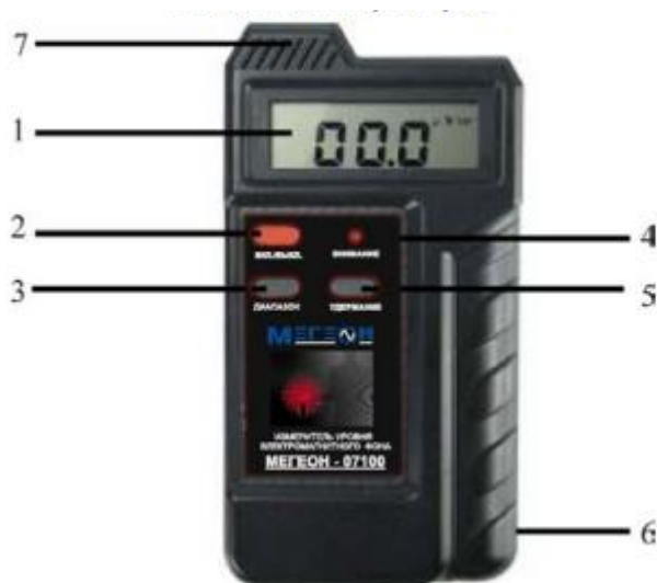
Рисунок 1 – Внешний вид измерителя напряженности уровня электромагнитного поля МЕГЕОН 07100:
