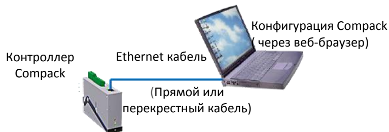
Рис. 5.4. Доступ к контроллеру через автономный ПК
