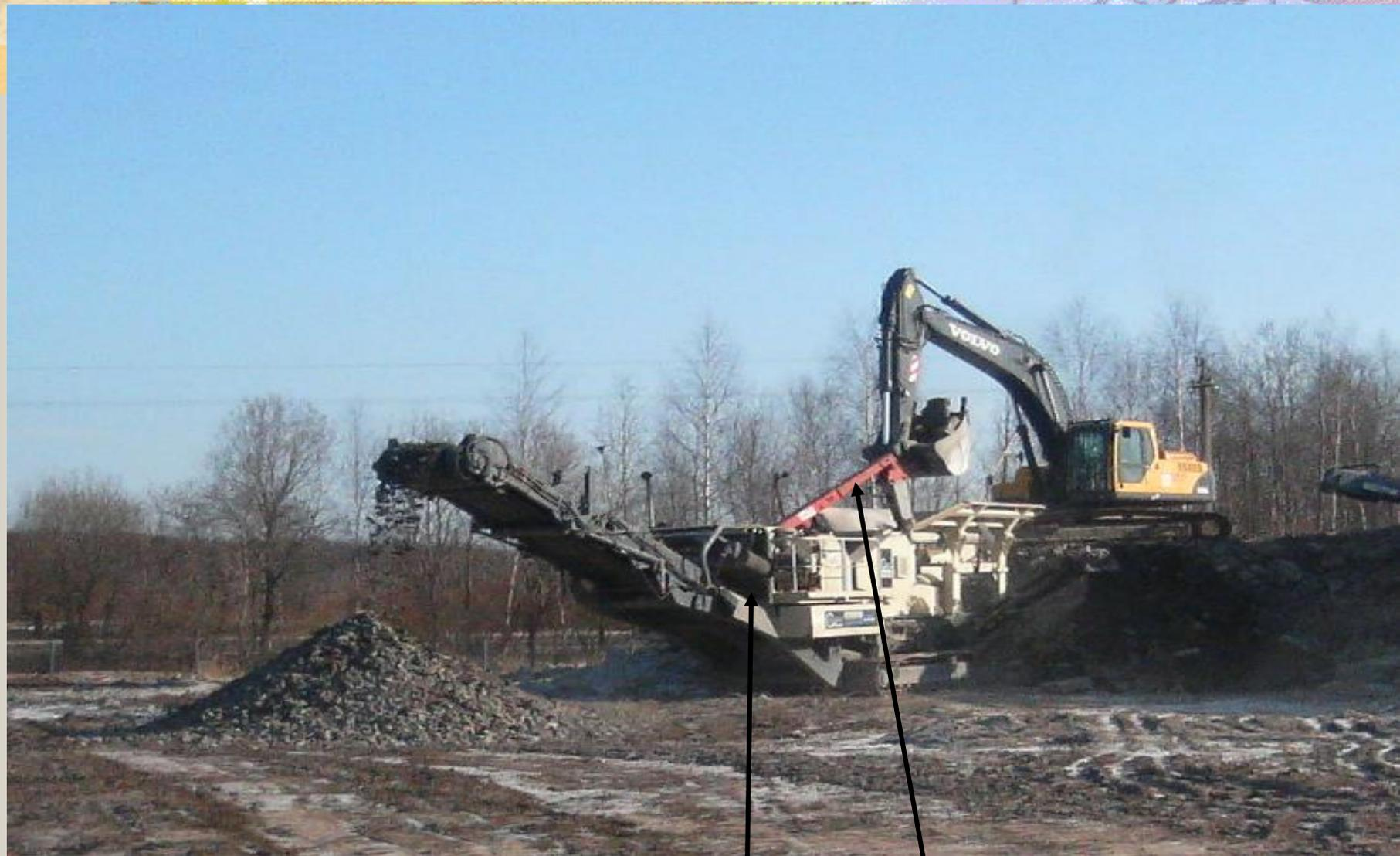
**Щековая дробилка с магнитным сепаратором для выделения металла и узлом для дробления крупных кусков**
