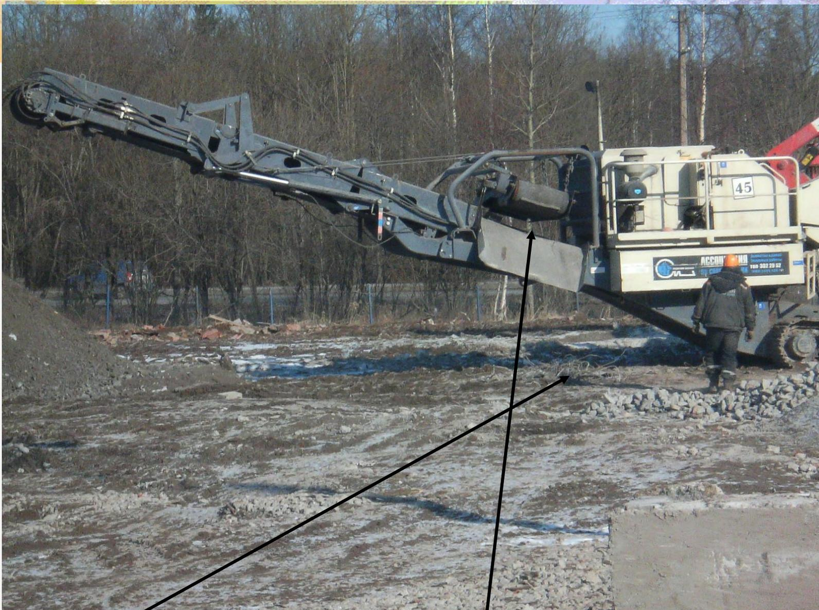
**Щековая дробилка с магнитным сепаратором для выделения металла**
