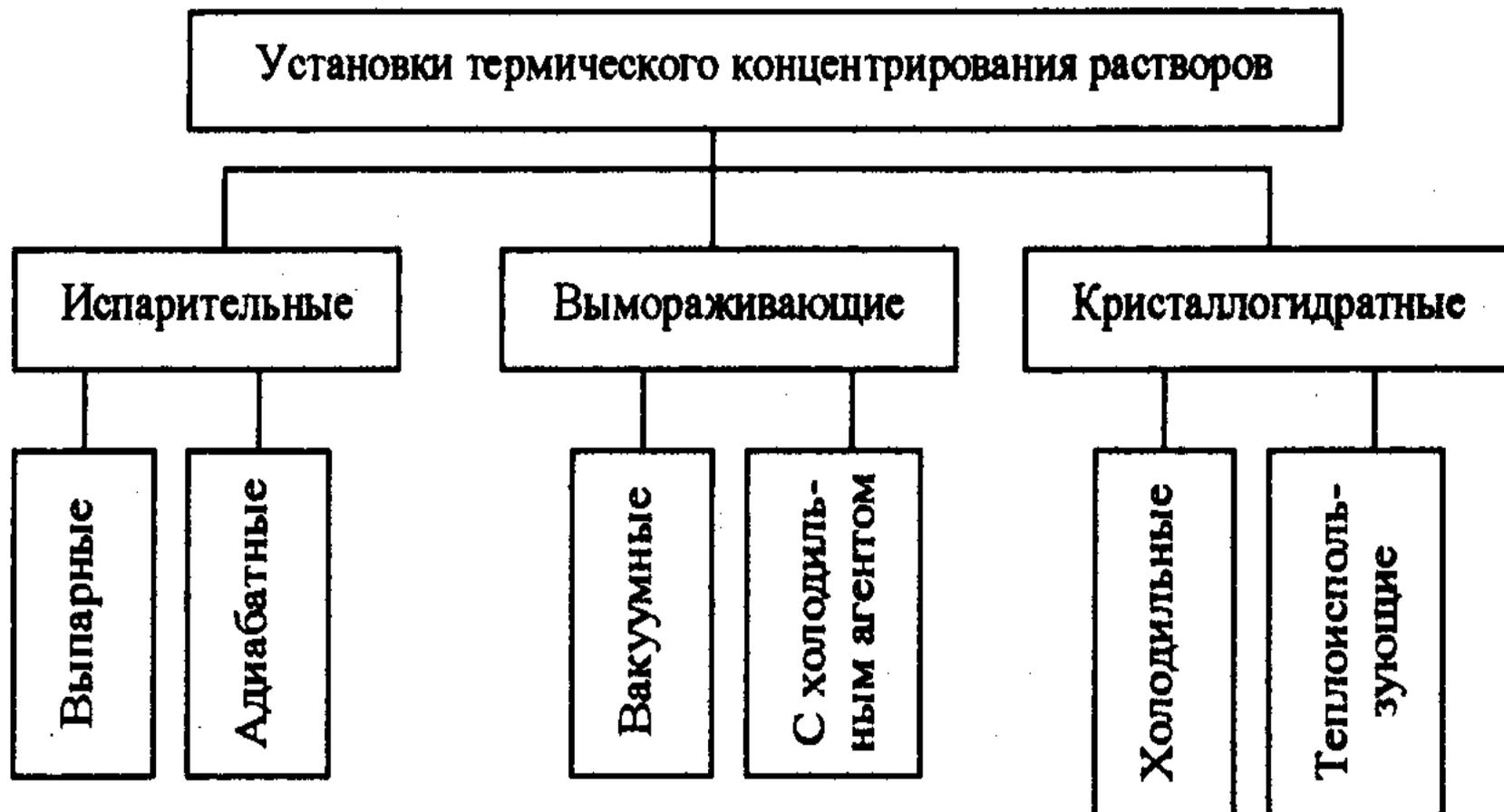
Классификация установок термического концентрирования растворов
