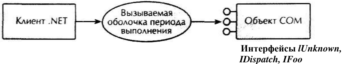
Рисунок 1.4. Взаимодействие .NET с COM через вызываемую оболочку периода выполнения.
