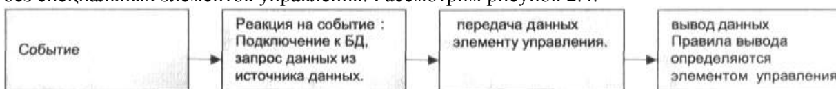
Рисунок 2.4. Процесс вывода данных из БД в ASP.NET
