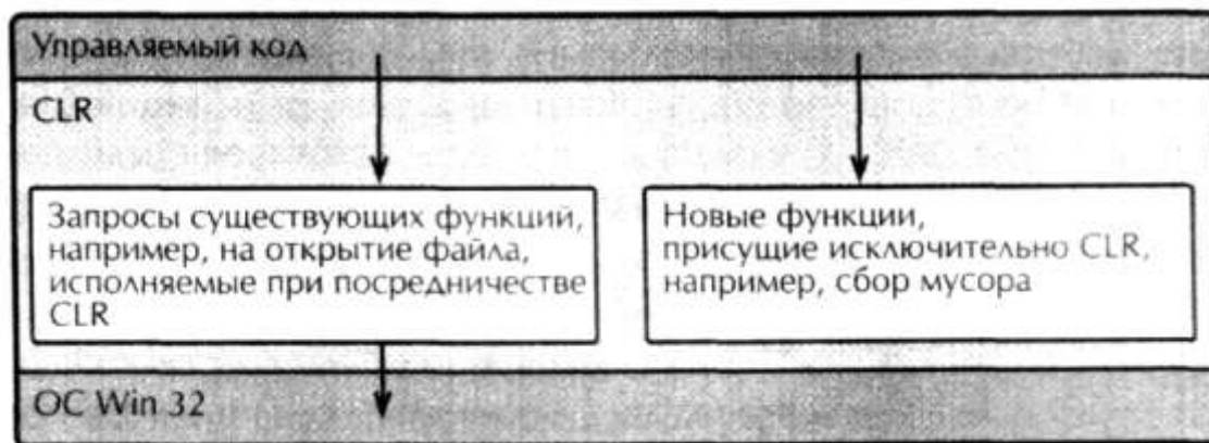
Рисунок 1.2. Управляемое исполнение программы в CLR.
