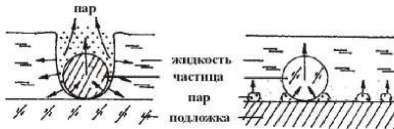
Рисунок. Иллюстрация физического механизма влажной лазерной очистки.
