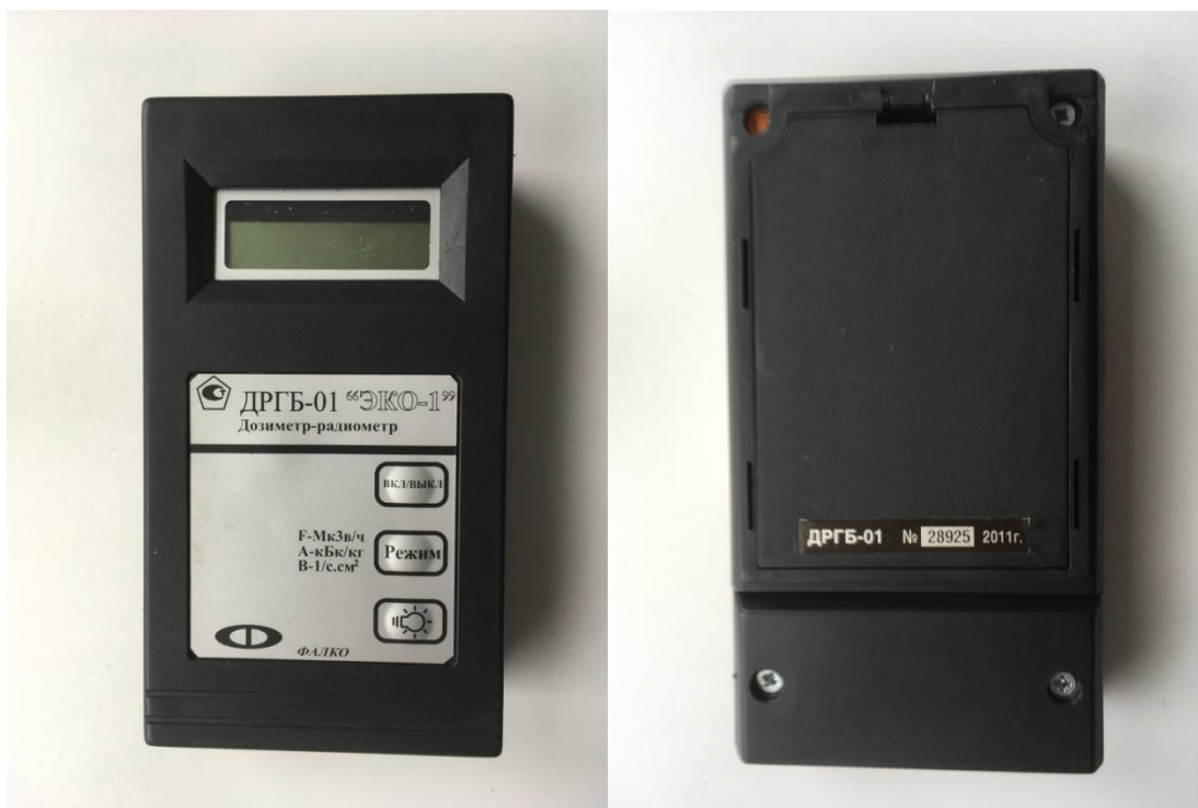
Рис. 2. Внешний вид дозиметра-радиометра ДРГБ-01 «ЭКО-1».
