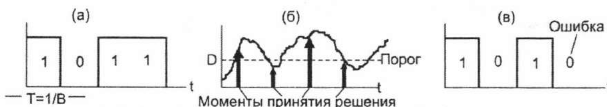
Рис. 6.1. Схема появления ошибки при восстановлении бинарного сигнала с модуляцией по интенсивности с NRZ кодированием; (а) сигнал на входе в линию, (б) сигнал на входе в регенератор, (в) сигнал на выходе регенератора.
