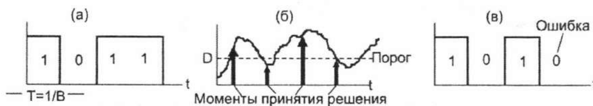
Рис. 5.1. Схема появления ошибки при восстановлении бинарного сигнала с модуляцией по интенсивности с NRZ кодированием; (а) сигнал на входе в линию, (б) сигнал на входе в регенератор, (в) сигнал на выходе регенератора.
