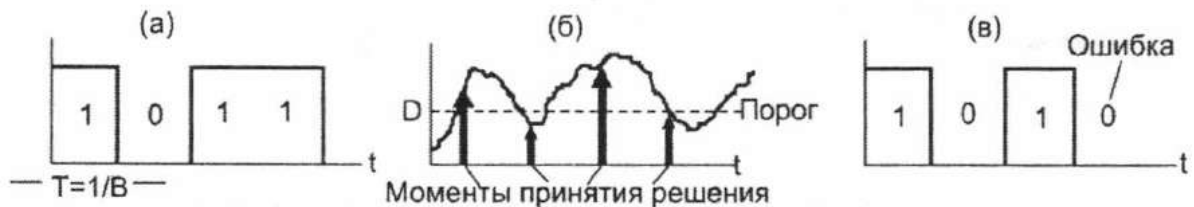
Рис. 1.1. Схема появления ошибки при восстановлении бинарного сигнала с модуляцией по интенсивности с NRZ кодированием; (а) сигнал на входе в линию, (б) сигнал на входе в регенератор, (в) сигнал на выходе регенератора.
