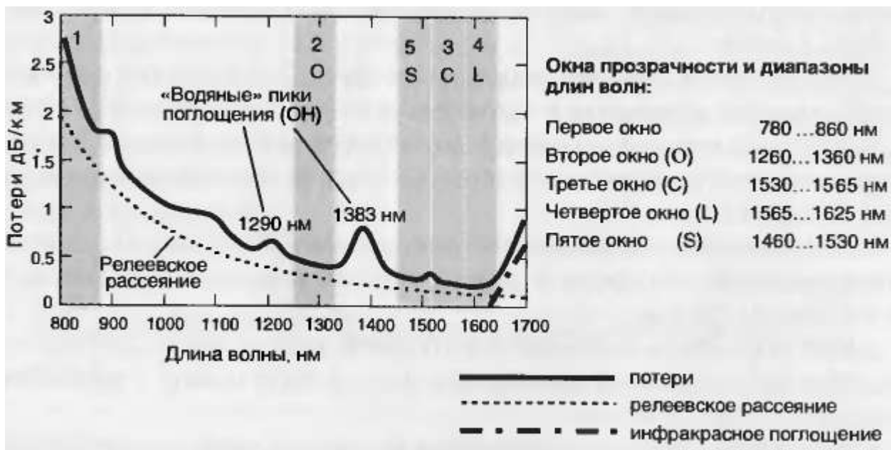
Рис. 2.8. Зависимость коэффициента затухания от длины волны и положение окон прозрачности в кварцевых ОВ.
