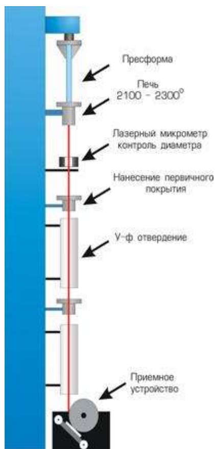
Рис. 3.6. Вытягивание ОВ из заготовки
