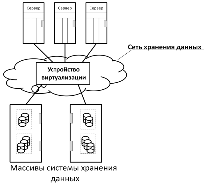
Рис.7.2. Конфигурация внутриполосной виртуализации системы хранения данных
