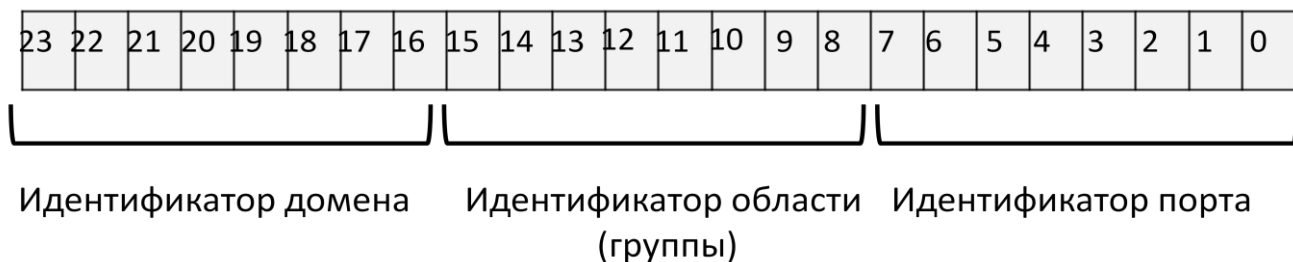
Рис. 6.7. 24-разрядный FC-адрес порта типа N_port
