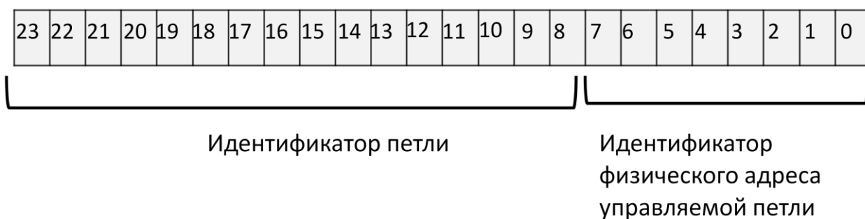
Рис. 6.9. 24-разрядный FC-адрес порта типа NL_port в открытой петле
