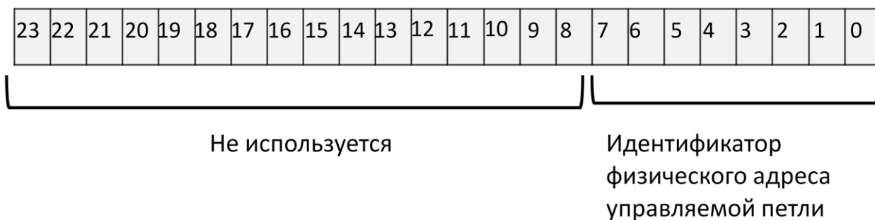
Рис. 6.8. 24-разрядный FC-адрес порта типа NL_port в частной петле
