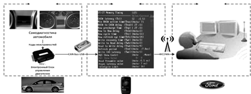
Рис. 11: Архитектура системы АПД.
