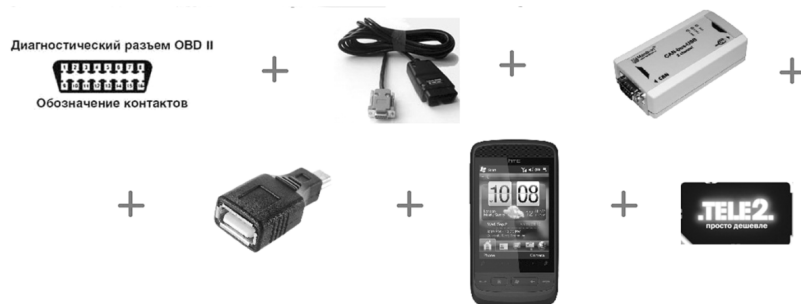
Рис. 17: Последовательность подключения оборудования к автомобилю.
