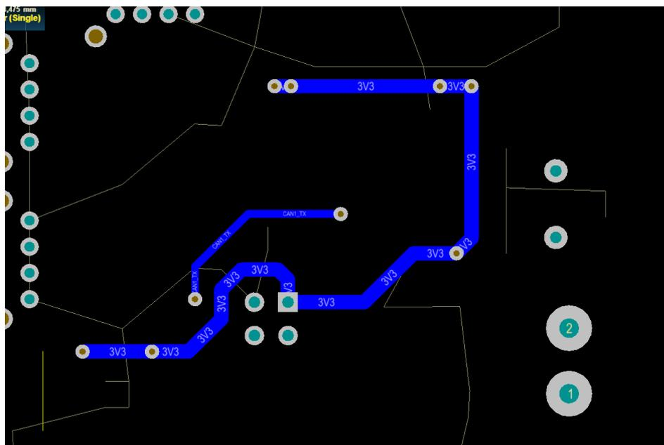
Рисунок 101 – Трассировка цепи питания 3V3 на слое Bottom Layer
