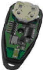
Активные RFID-метки обладают собственным источником питания и не зависят от энергии считывателя, вследствие чего они читаются на дальнем расстоянии (до 300 м), имеют большие размеры, больший объем памяти и могут быть оснащены дополнительной электроникой. Однако, такие метки наиболее дороги, а у батарей ограничено время работы.
