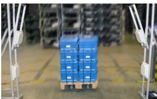
Портальные (воротные) зоны регистрации окружают антеннами, подключенными к стационарному считывателю, зону перемещения объектов с метками с боковых сторон и/или сверху. Например, регистрация меток товаров на провозимой паллете, меток персонала, проходящего через зону контроля, меток товаров, двигающихся по транспортерной ленте, меток книг, проносимых пользователями на выходе из библиотеки. Типичные размеры порталной зоны — до 3 метров в ширину и высоту.
