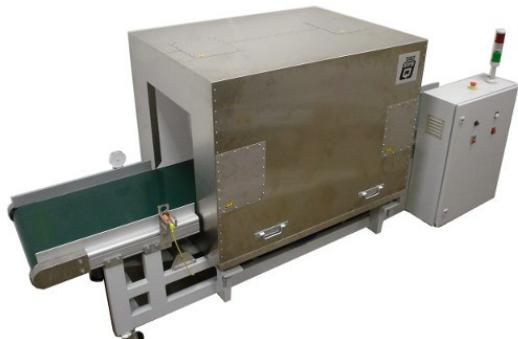
При необходимости регистрации большого числа меток в небольшой зоне с линейными размерами менее метра оправдано использование тоннелей или боксов, содержащих antennы, окружающие зону регистрации с возможно большего числа сторон и направлений, и внешние экранирующие элементы, предотвращающие «паразитные» регистрации меток снаружи.
