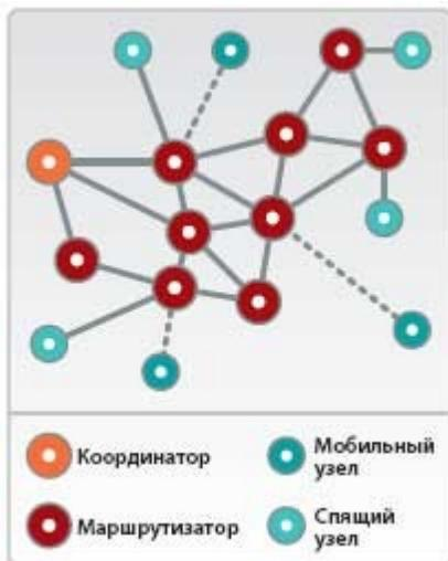
В сети ZigBee существует 3 типа узлов: координатор (ZC), роутер/маршрутизатор (ZR), конечные устройства (ZED), которые делятся на спящие устройства и мобильные устройства.
