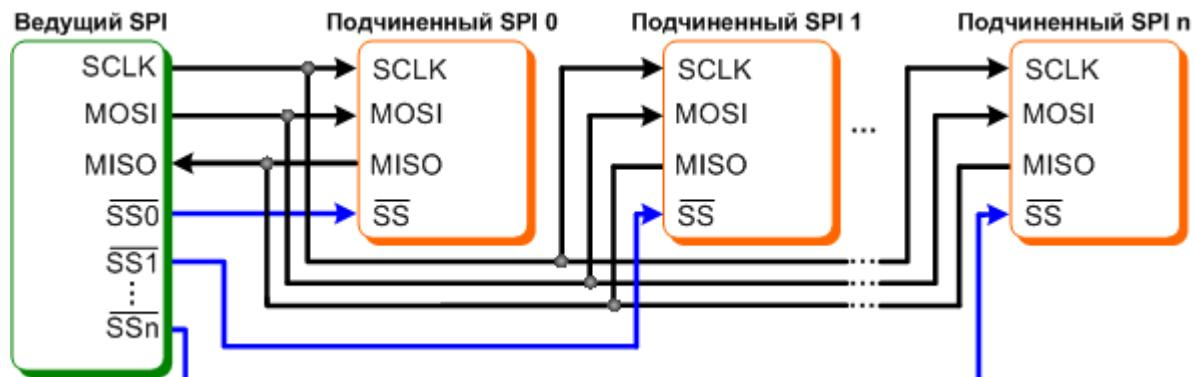
Независимое подключение к шине SPI.
