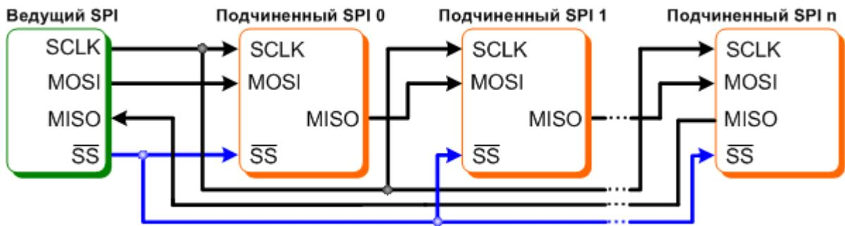
Каскадное подключение к шине SPI (возможно при совместимости ведомых устройств по режимам работы).
