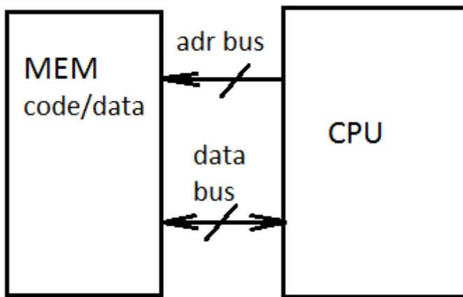
Такая архитектура наиболее характерна для микропроцессоров, ориентированных на использование в компьютерах. Примером могут служить микропроцессоры семейства x86. Эти микропроцессоры относятся к CISC-процессорам.
