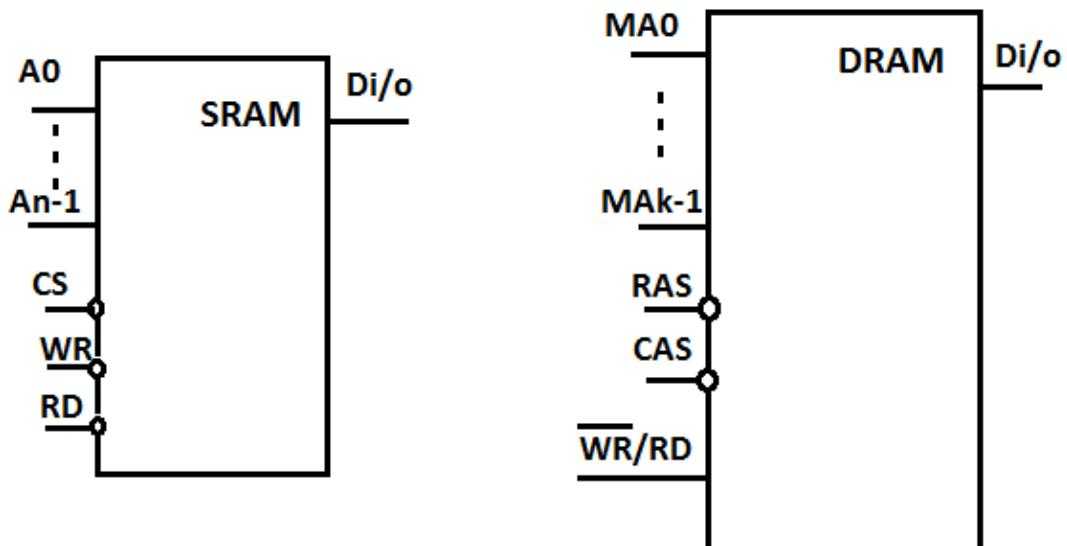
Память SRAM, имеющая триггерную матрицу накопителя, наоборот, обладает сверхвысоким быстродействием. Если рассматривать матрицу накопителя, имеющую  $2^n$  ячеек, то в SRAM имеется  $n$  адресных входов, распределенных на дешифраторы строки и столбца, вход CS (chip select),
