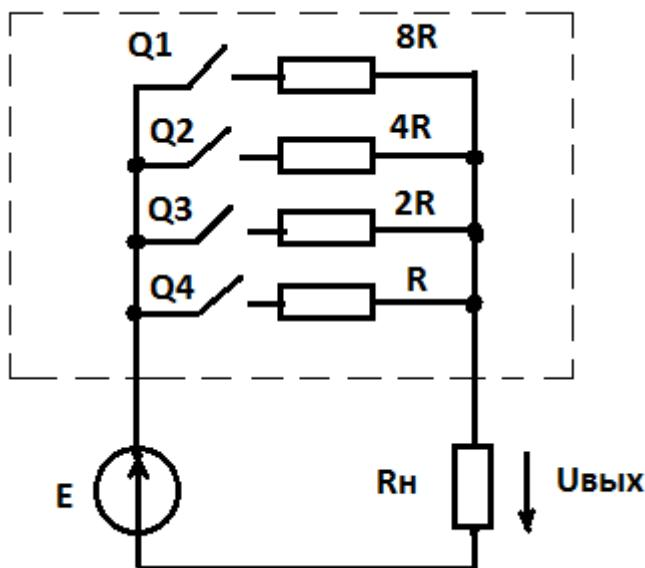
ЦАП преобразует цифровой двоичный код  $Q_4Q_3Q_2Q_1$  в аналоговую величину, обычно напряжение  $U_{\text{вых}}$ . Каждый разряд двоичного кода имеет определенный вес  $i$ -го разряда вдвое больше, чем вес  $(i-1)$ -го. Работу ЦАП можно описать следующей формулой:
