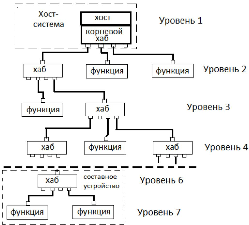
Порт хаба или функции, подключаемый к хабу более высокого уровня, называется восходящим портом (upstream port), а порт хаба, подключаемый к хабу более низкого уровня, или к функции, называется нисходящим портом(downstream port).
