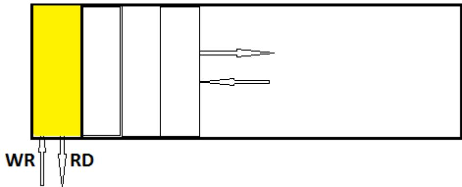
Адресуемая ячейка, через которую производится запись и считывание информации называется вершиной стека.
