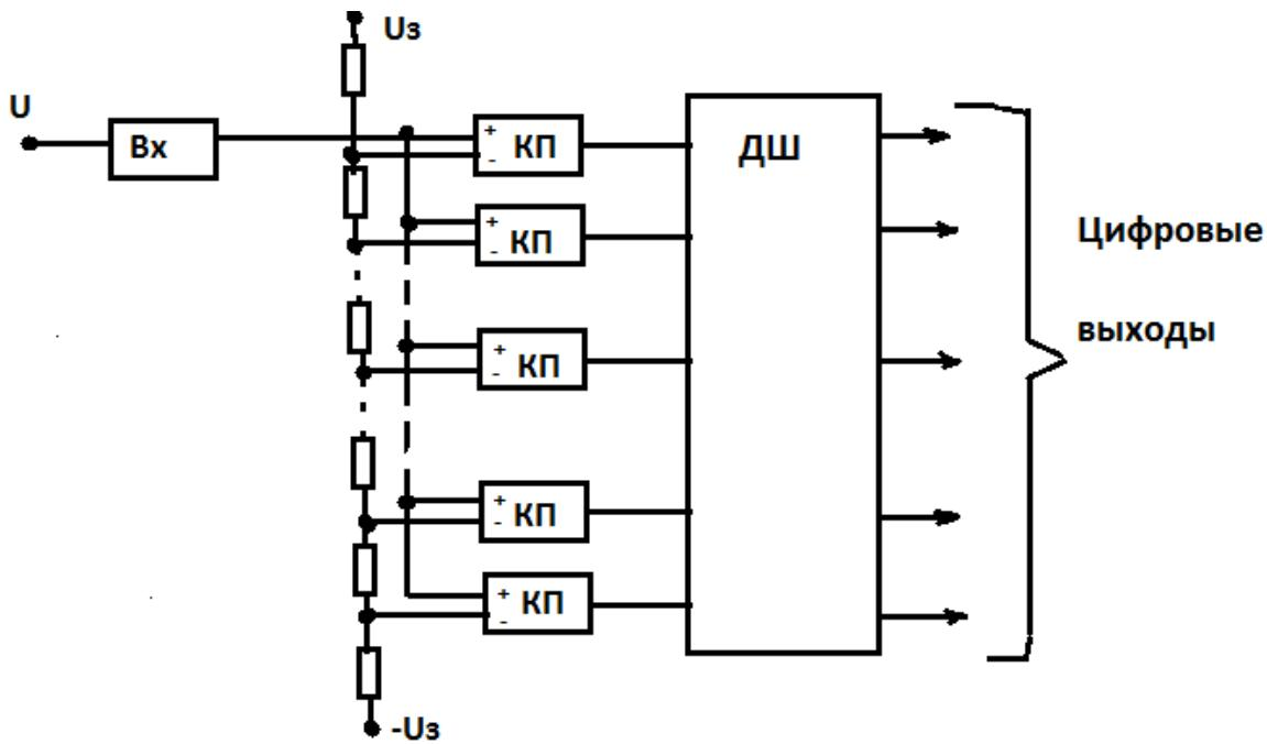
Здесь входная аналоговая величина  $U_0$  с выхода схемы ВХ сравнивается с помощью  $2^{n+1} - 1$  компараторов с  $2(2^n - 1)$  эталонными уровнями, образованными делителями из резисторов равного сопротивления. При этом срабатывают  $n$  младших компараторов, образующих на выходах схем И-НЕ нормальный единичный код, затем который с помощью специального кодопреобразователя ДШ преобразуется в двоичный выходной сигнал.
