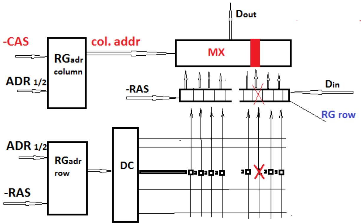
На рисунке изображен процесс поиска ячейки и считывания информации.
