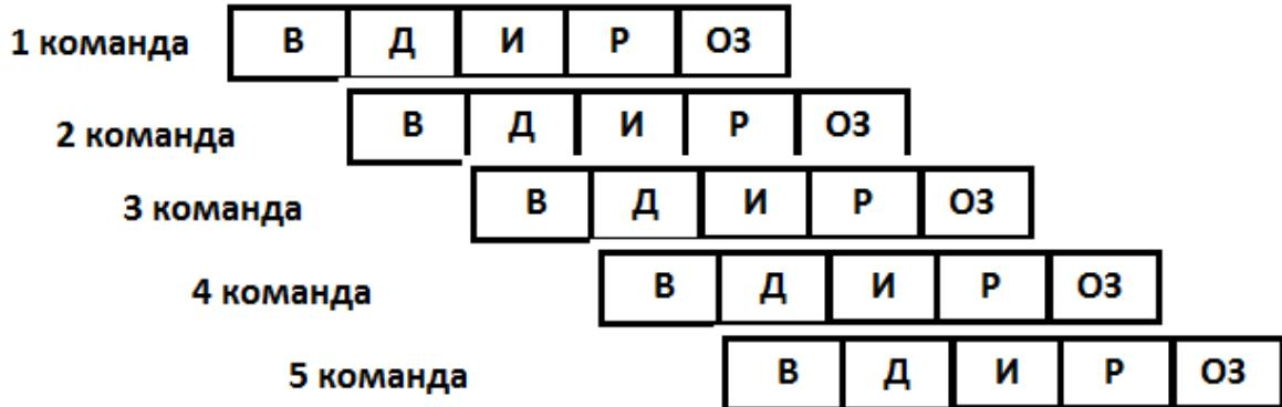
Рассмотренный выше случай – пятиступенчатый конвейер, но для разных процессоров возможно объединение 4 и 5 или 3, 4 и 5 этапов, в этих случаях мы имеем четырех- или трехступенчатый конвейер.
