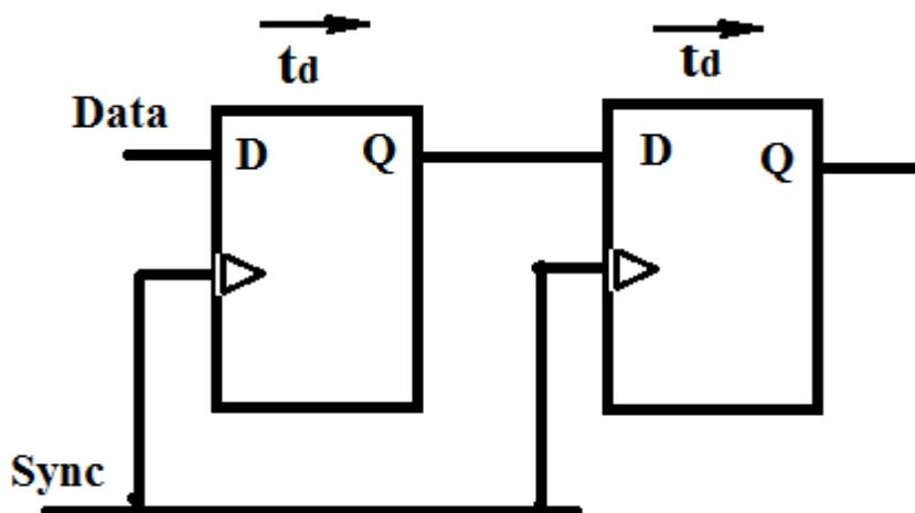
В регистрах шины SPI выборка и установка производятся по противоположным фронтам импульса синхронизации. Исходя из этого, SPI имеет 4 режима работы.
