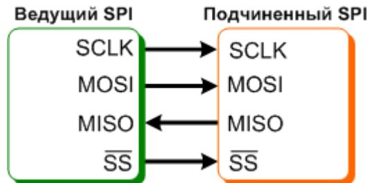
Если в структуре обмена присутствует несколько ведомых устройств, то их подключения к ведущему возможны одним из 2-х способов: независимое подключение или каскадное подключение.
