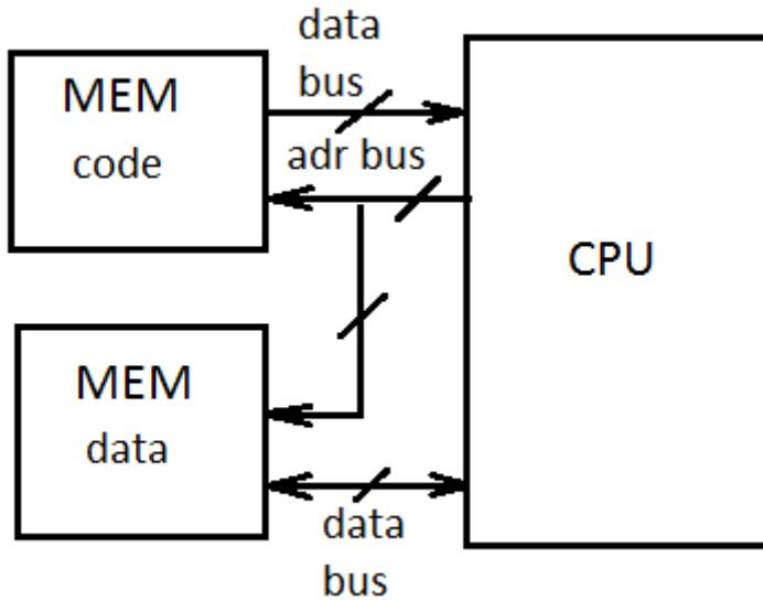
Такая архитектура была создана под использование RISC-процессоров.
