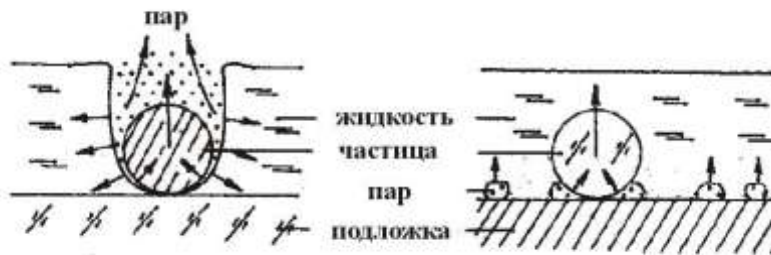
Рисунок. Иллюстрация физического механизма влажной лазерной очистки.
