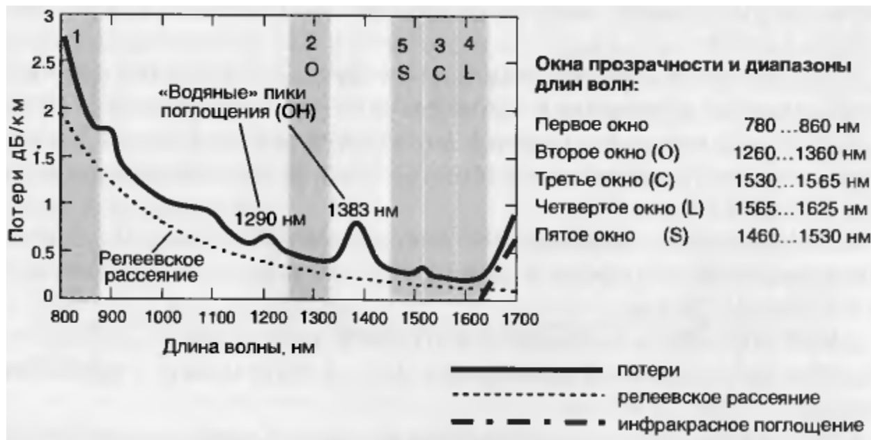
Рис.8.1. Зависимость коэффициента затухания от длины волны и положение окон прозрачности в кварцевых ОВ.
