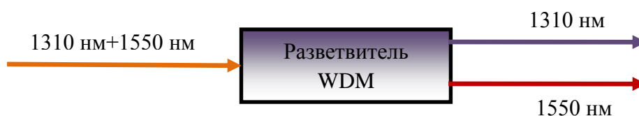
Рис.3.12. Схема WDM-сплиттера. Работа при разделении каналов.
