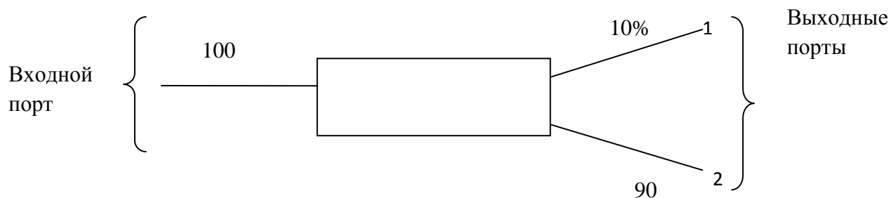
Рис.3.2. Работа асимметричного разветвителя.
