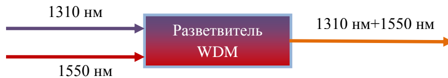
Рис.3.13. Схема WDM сплиттера. Работа при объединении каналов.
