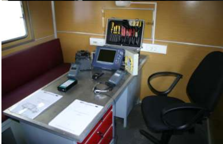
Передвижная лаборатория по монтажу, ремонту и восстановлению волоконно-оптического кабеля.
