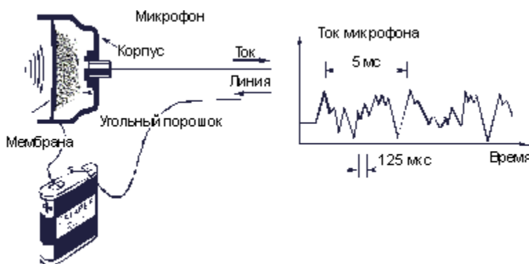
Рисунок 10 - Превращение звука в электрический сигнал с помощью микрофона.
