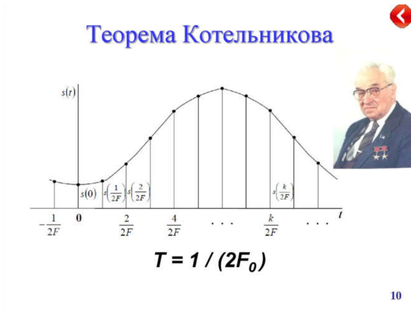
Рисунок 3 – Дискретный по времени сигнал по теореме Котельникова
