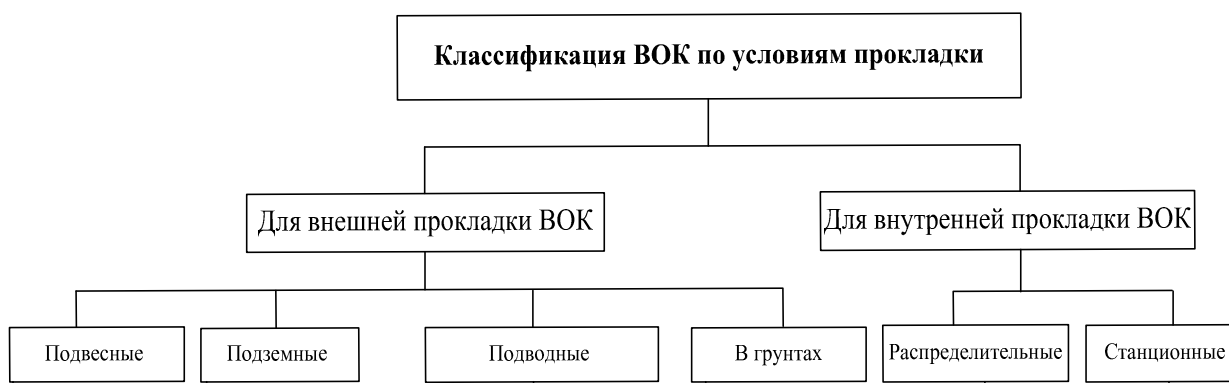
Рисунок 9 – Классификация ВОК по условиям прокладки
