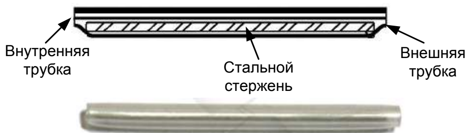
Рис. 2.25. Термоусаживаемая гильза. Чертеж и внешний вид.
