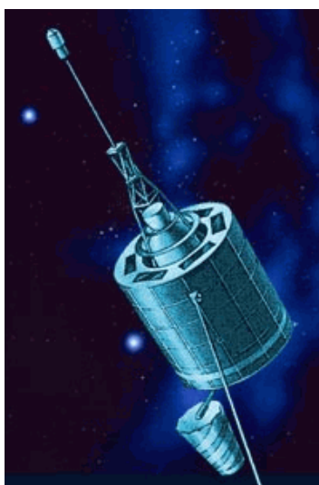
Рис. 2.2. Космический аппарат системы КОСПАС-САРСАТ, используемый на низких околополярных круговых орбитах
