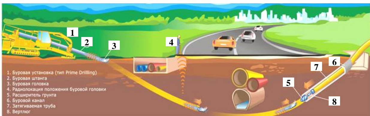
Рис. 5.8. Схема организации перехода через автодорогу: 1 – буровая установка; 2 – буровая штанга; 3 – буровая головка; 4 – радиолокация положения буровой головки; 5 – расширитель грунта; 6 – буровой канал; 7 – затягиваемая труба; 8 – вертлюг
