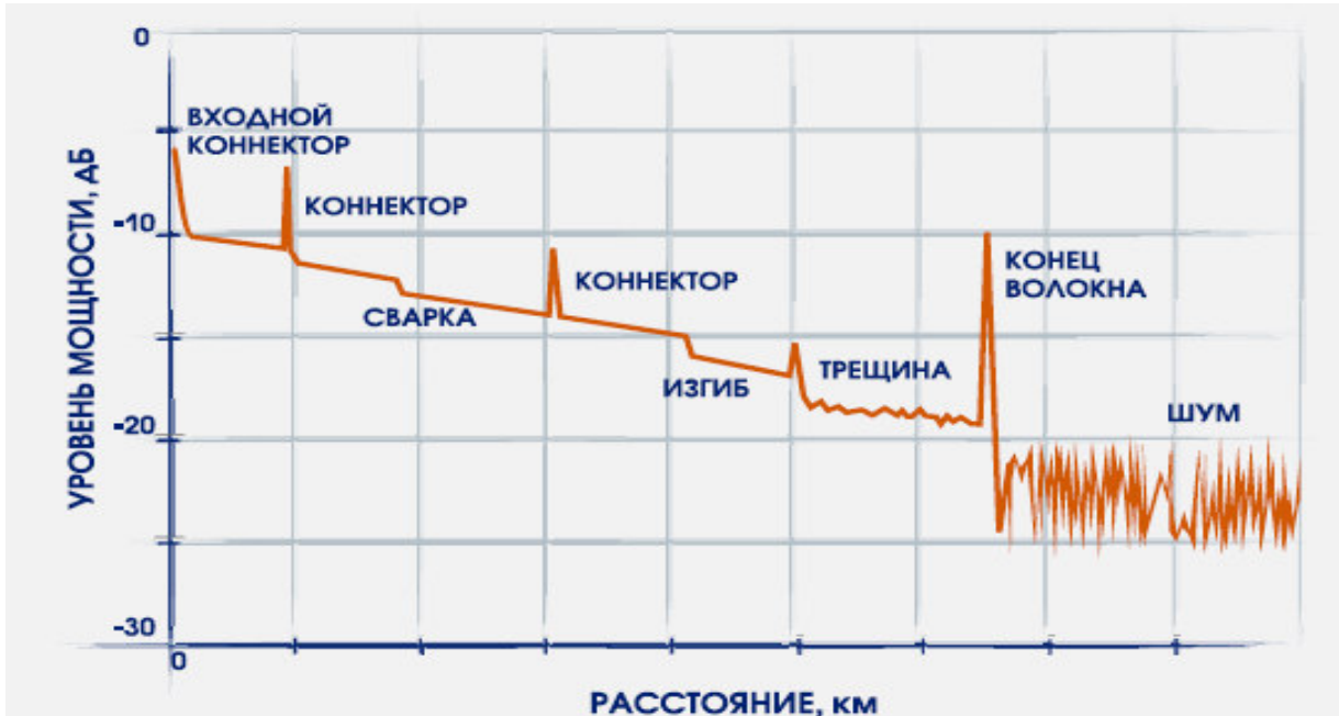
Рис. 7.1. События, которые отображаются на рефлектограмме
