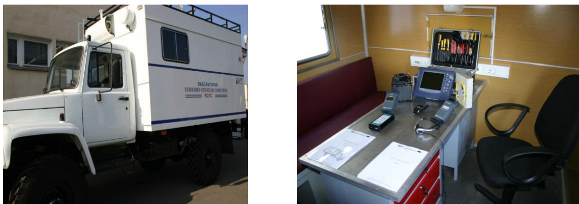
Рис. 6.16. Передвижная лаборатория для монтажа ВОК (ЛИОК)
