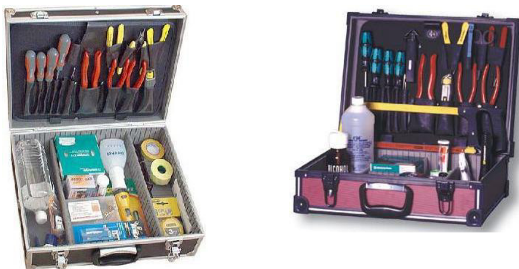
Рис. 6.1. Стандартизованный набор инструментов для подготовки оптического волокна
