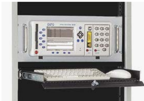
Рис. 6.9. Простейшая система мониторинга ВОЛС на базе одного рефлектометра
