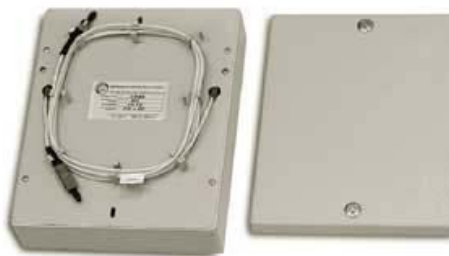
Рис. 6.24. Катушка нормализующая: тип оптического волокна (по заказу) SSF, DSF, +NZDS, –NZDS; длина волокна – 1000 м; тип оптических коннекторов (по заказу) FC, SC, ST, LC; габариты, мм – 210×170×60
