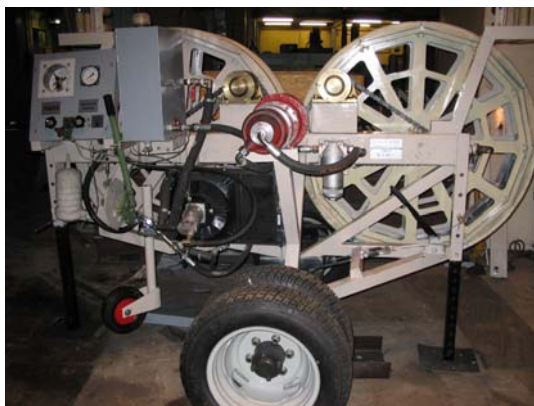
Рис. 3.19. Натяжная и тормозная машина для самонесущего ВОК
