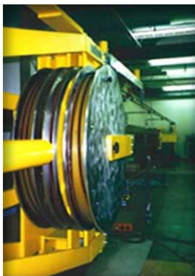
Рис. 5.5. При укладке ВОК на барабан кабель может испытывать различные нагрузки: а – измеренные методом фазового набега, б – измеренные бриллиантовым рефлеректометром
