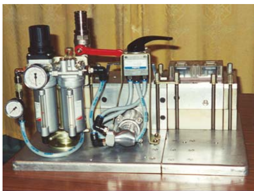
Рис. 3.4. Инжектор ПСИ-1 для задувки кабеля
