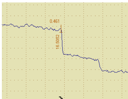
Рис. 3.32. Пример рефлектограммы плохого стыка
