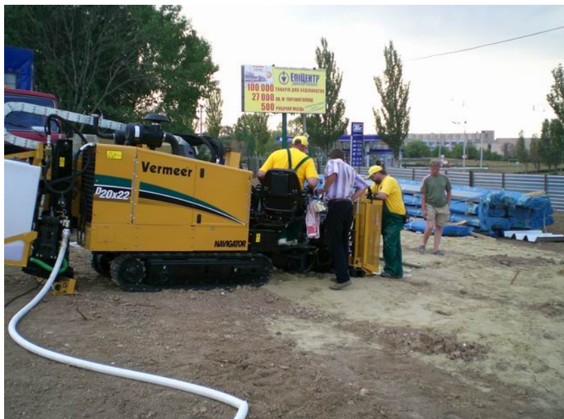
Рис. 3.8. Машина для горизонтально-направленного бурения
