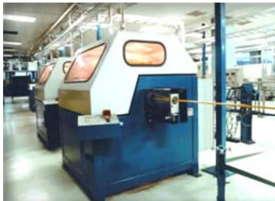
Рис. 5.4. Вытяжка оптических волокон из заготовки
